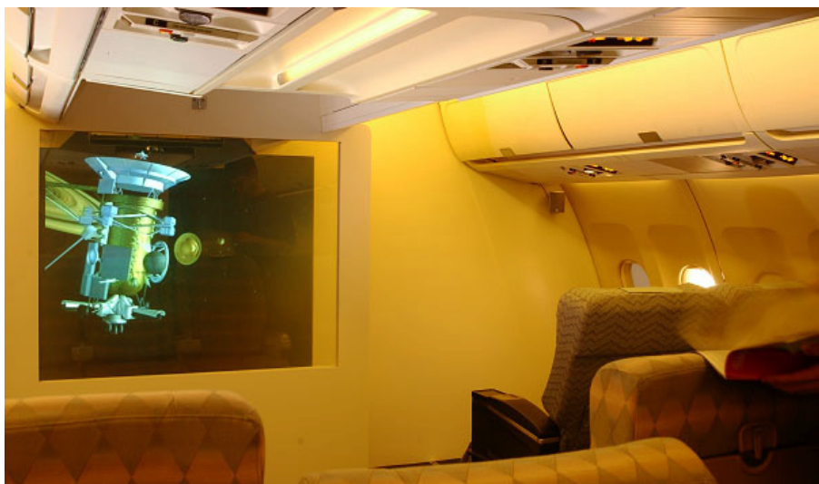
Bild 1: Brillante Bilder trotz einfallendem Tageslicht. Ein holografischer Projektionsschirm in Kombination mit einem Leuchtdioden-Beamer, eingebaut in einem A340 Kabinen Mock-up.*
