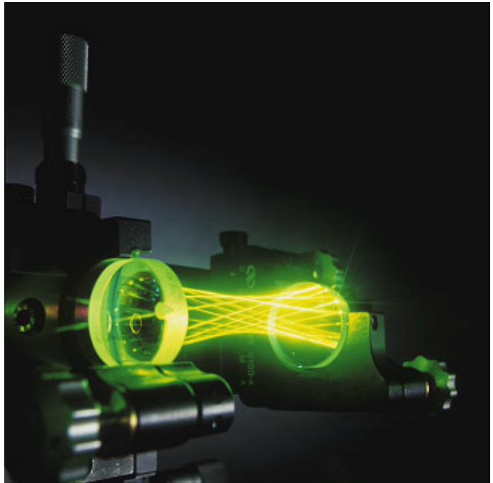
Bild 3: Versuchsaufbau für eine Multi-Reflektionszelle zur mehrfachen Spiegelung eines Laserstrahls. Diese Multi-Reflektionszelle wird für ein Laserionenmobilitätsspektrometer verwendet, das in der Lage ist, sekundenschnell kleinste Spuren von Sprengstoffen zu detektieren.*
