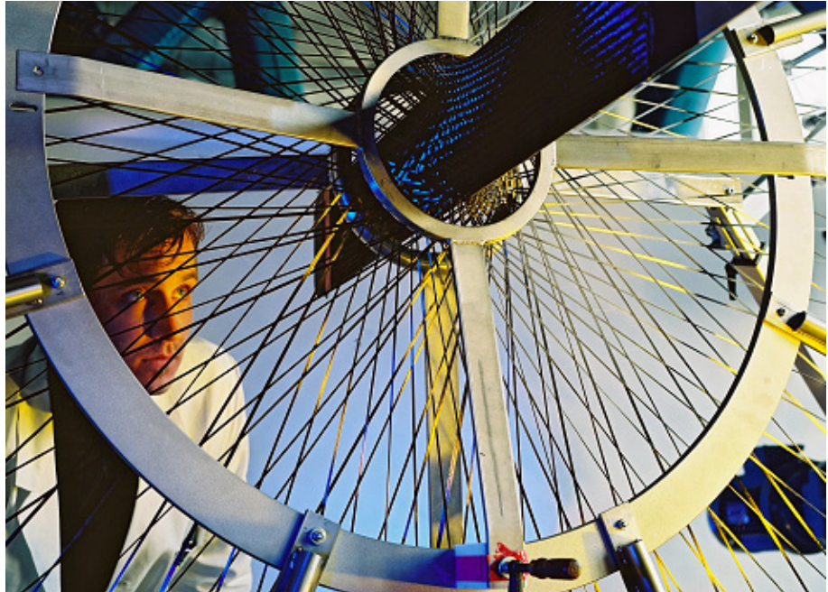
Bild 2: Automatisierte Herstellung von Faserhalbzeugen für Bauteile aus Faserverbundwerkstoffen durch roboterunterstütztes Flechten. Bis zu 216 Kohlefaserfäden werden um einen Kern geflochten, um damit ein Strukturbauteil zu erhalten, das eine optimierte Faseranordnung aufweist.*
