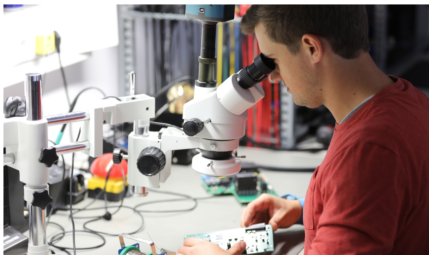
Prüfung einer elektronischen Baugruppe unter dem Mikroskop auf mögliche Lötfehler. (Foto: Systemtechnik LEBER GmbH & Co. KG).
